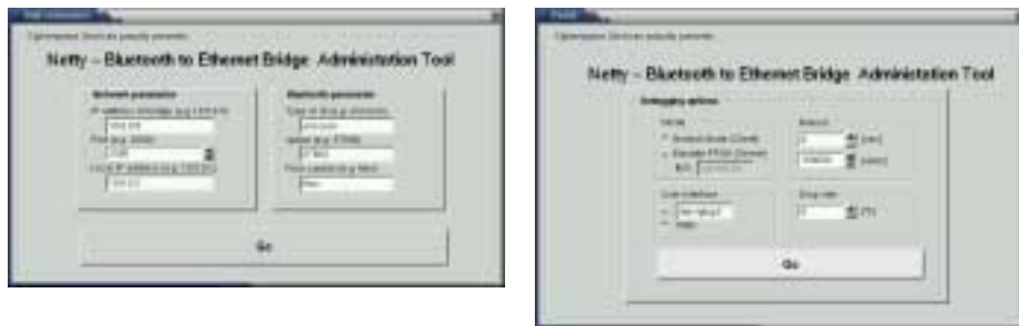
Abbildung 4-5 Screenshots vom GUI: Das erste Formular mit den Netzwerk- und Bluetooth-Parametern, das zweite mit den optionalen Einstellungen.
